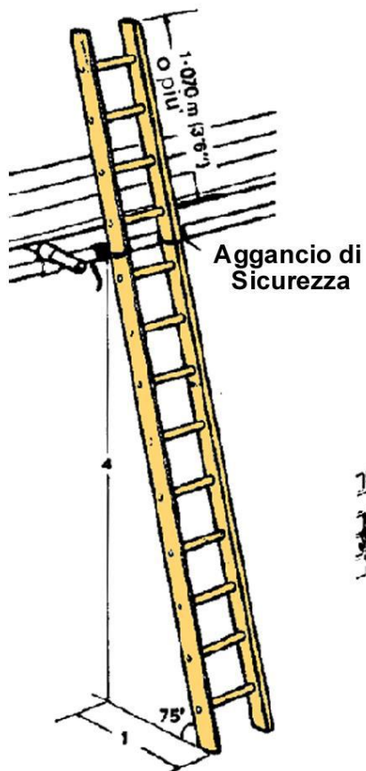
Scala correttamente installata ed assicurata
